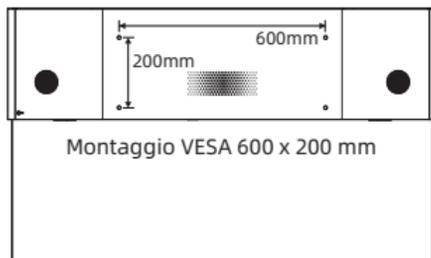
I quattro fori di montaggio sul retro sono 600 x 200 mm.
