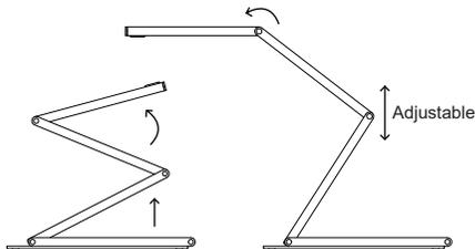
(3) Ajuste la cabeza de la cámara hasta que quede horizontal con la superficie de captura. Extienda completamente el brazo para cubrir un área A3.
